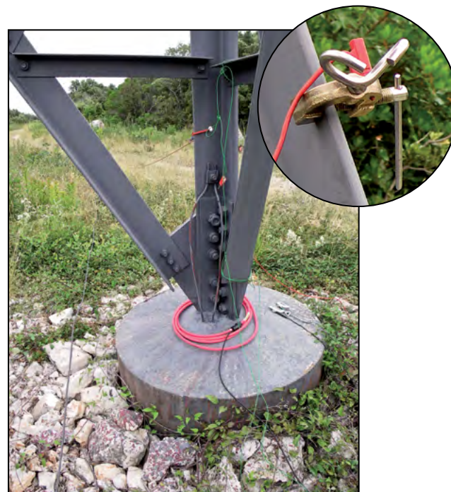
Die AmpFLEX™-Strommessschleifen lassen sich um jeden Mastfuß legen.
