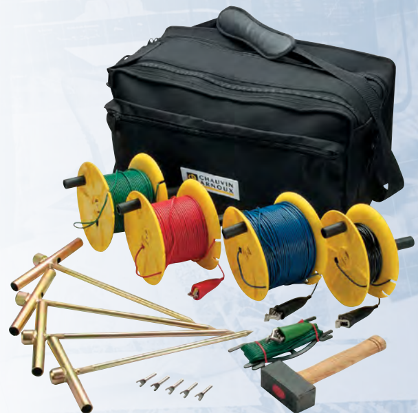
Zubehörset für Erdungs- und spezifische Erdwiderstandsmessungen nach jedem beliebigen Verfahren
