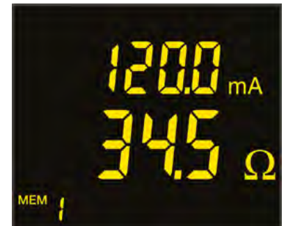
Standardmodus: Impedanz und Fehlerstrom
