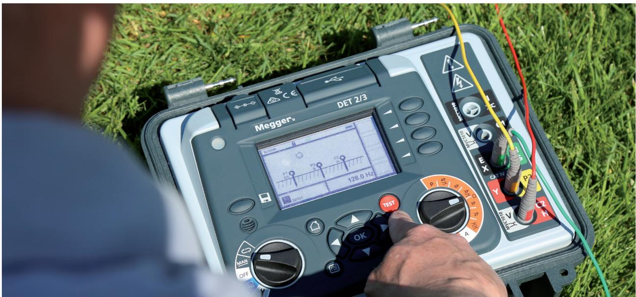
Sowohl die Analysen von Bodenwiderständen vor der Errichtung von Erdungssystemen als auch die Ermittlung ihrer Widerstände nach deren Fertigstellung sind zwei sehr spezialisierte Bereiche in der Elektrotechnik. Sie werden immer dann notwendig werden, wenn elektrische Anlagen nach DIN VDE 0100-600 neu errichtet oder nach DIN VDE 0100 / 0105 verändert oder wiederholt überprüft werden müssen.
