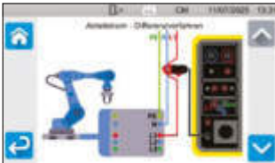
Ableitstrommessung nach dem Differenzverfahren mit Zange
