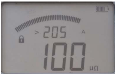
Die Abbildungen zeigen, dass der Stromwert unter 219 A und über 205 A war.
