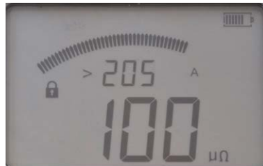
Min. Strom während der Prüfung war 205 A.
