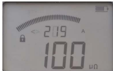
Max. Strom während der Prüfung war 219 A.
