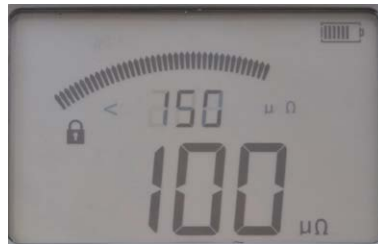
Hier war die P/F-Grenze auf 150 µΩ eingestellt und der Messwiderstandswert ist 100 µΩ.
