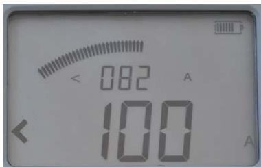
Die Abbildung zeigt, dass der Prüfstrom unter 100 A war.
