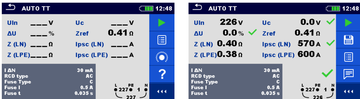
Abbildung 7.130: Beispiele für Ergebnisse der AUTO TT Messung
