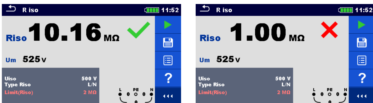
Abbildung 7.9: Beispiele für Ergebnisse der Isolationswiderstandsmessung
