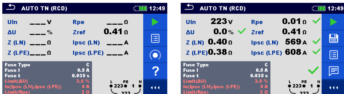
Abbildung 7.133: Beispiele für Ergebnisse der AUTO TN (RCD) Messung
