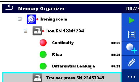
Abbildung 5.5: Status – Messungen abgeschlossen mit Ergebnis durchgefallen
