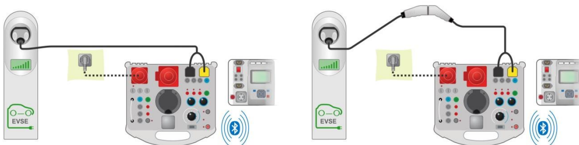
Abbildung 6.103: Diagnostischer Test - Ev-Simulator und Fehler Teilprüfungen - Verbindung mit EVSE
