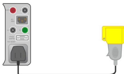
Abbildung 9.2: Anschließen des 110-V-Testadapters (A 1474)
