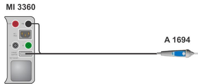
Abbildung 9.3: Anschließen des Tip-Commanders (A 1694)
