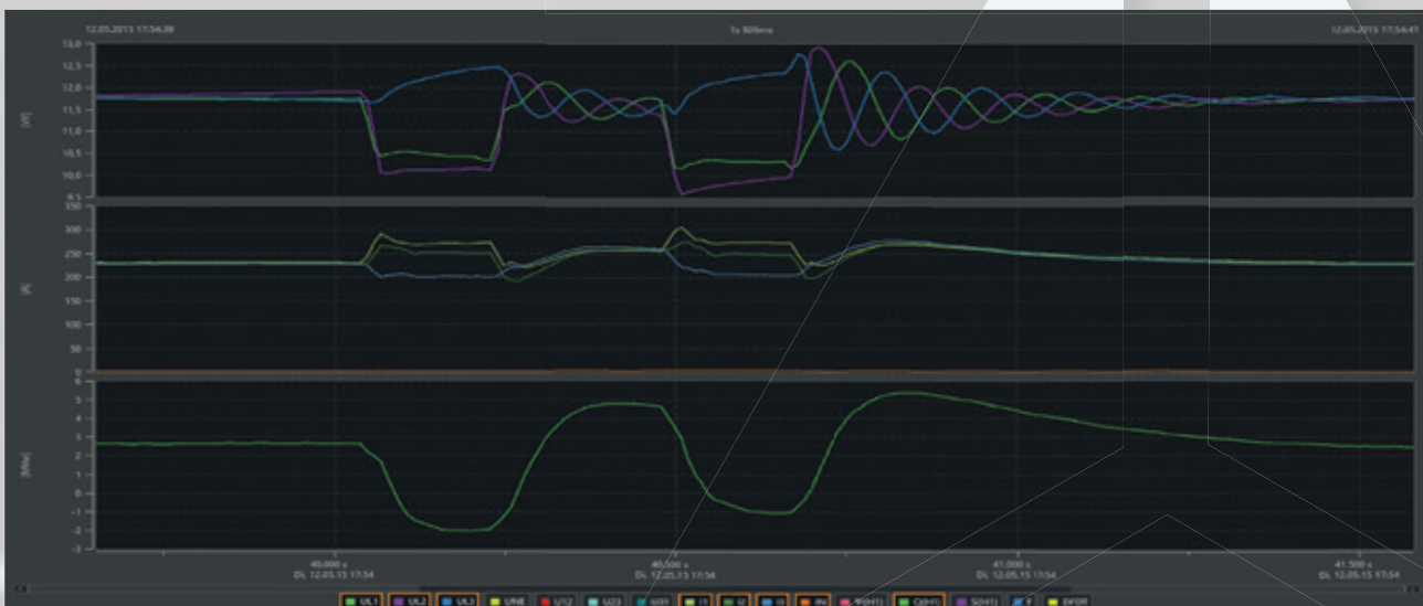
Bild 7: Reaktion Windpark auf einen Spannungseinbruch
